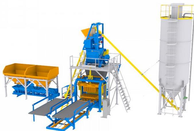
**Высокопроизводительный комплекс, предназначенный для изготовления мелкоштучных вибропрессованных изделий: стеновых блоков, брусчатки, тротуарных и дорожных бордюров, лотков, кирпичей и облицовочных камней.**
